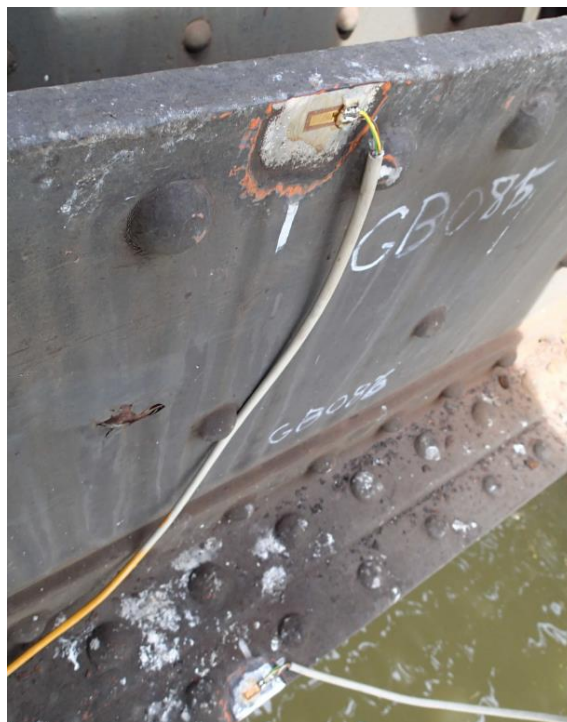
Obr. 24 Znáznornění polohy tenzometru na dolním pase
