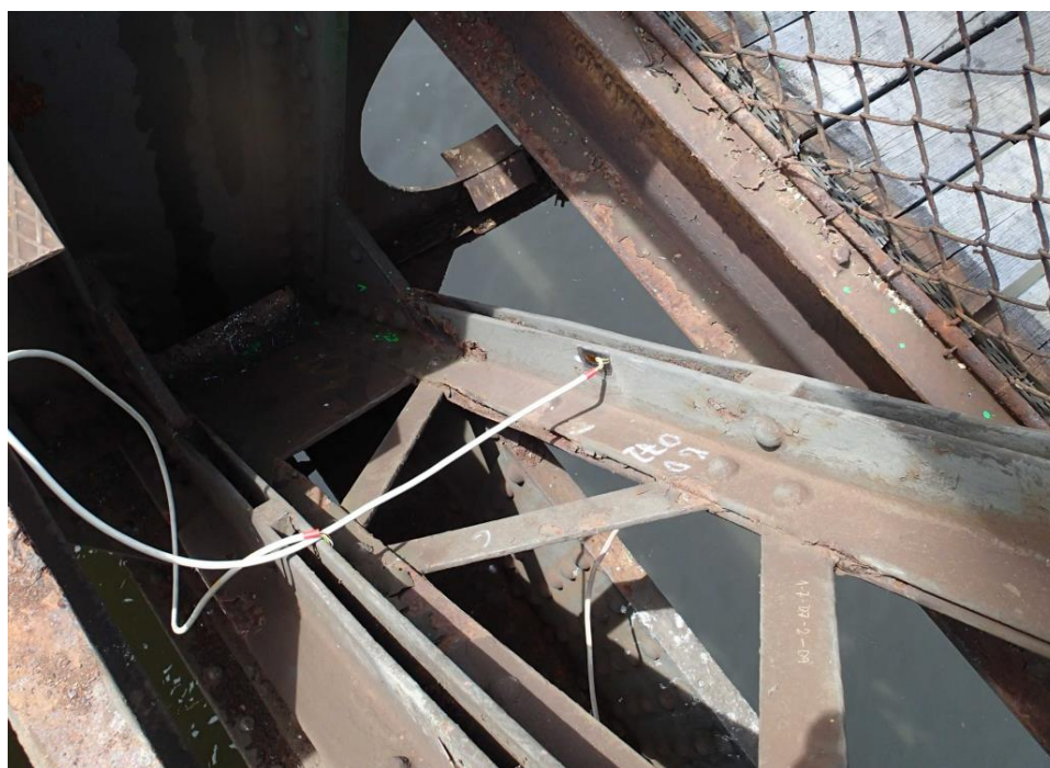
Obr. 23 Znáznornění polohy tenzometru na diagonále
