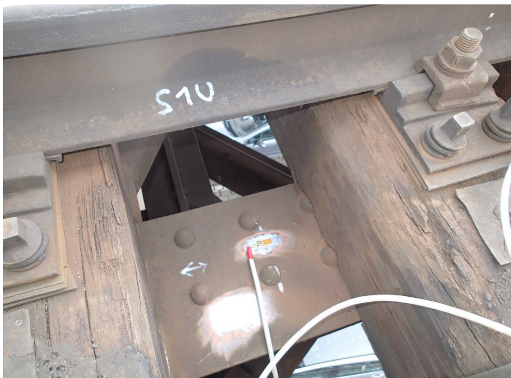
Obr. 18 Znáznornění polohy tenzometru na horní pásnici podélníku
