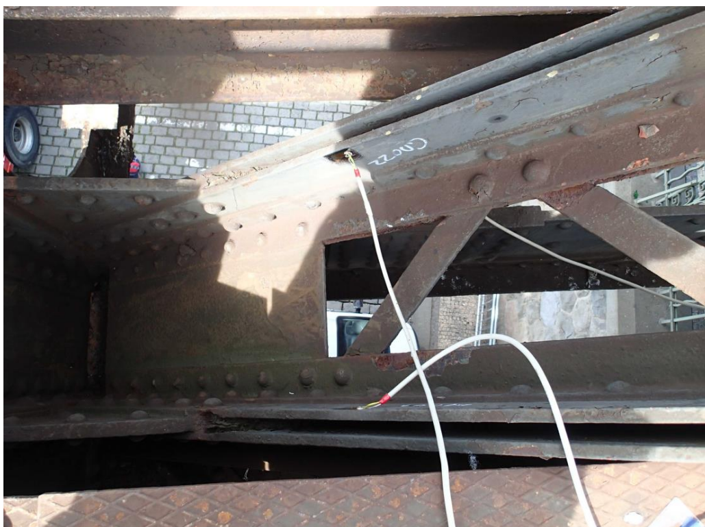
Obr. 22 Znáznornění polohy tenzometru na diagonále
