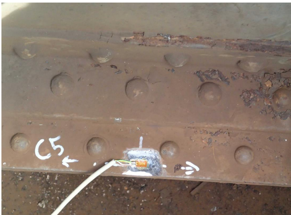
Obr. 20 Znáznornění polohy tenzometru na dolní pásnici příčniku
